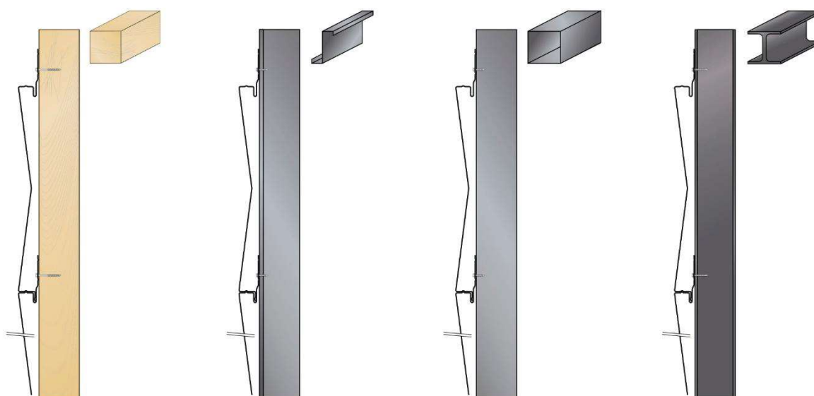
Figure 02 – Nature du support pour choix des vis d'assemblage
