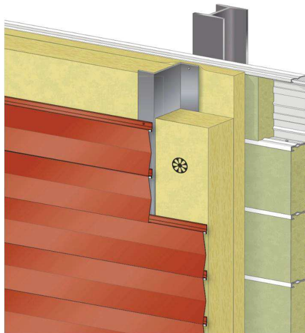
Bardage double peau pose horizontale
