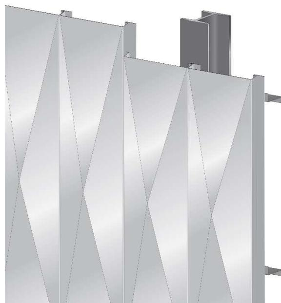
Figure 08.1a et b - Types de pose des lames KARBON
