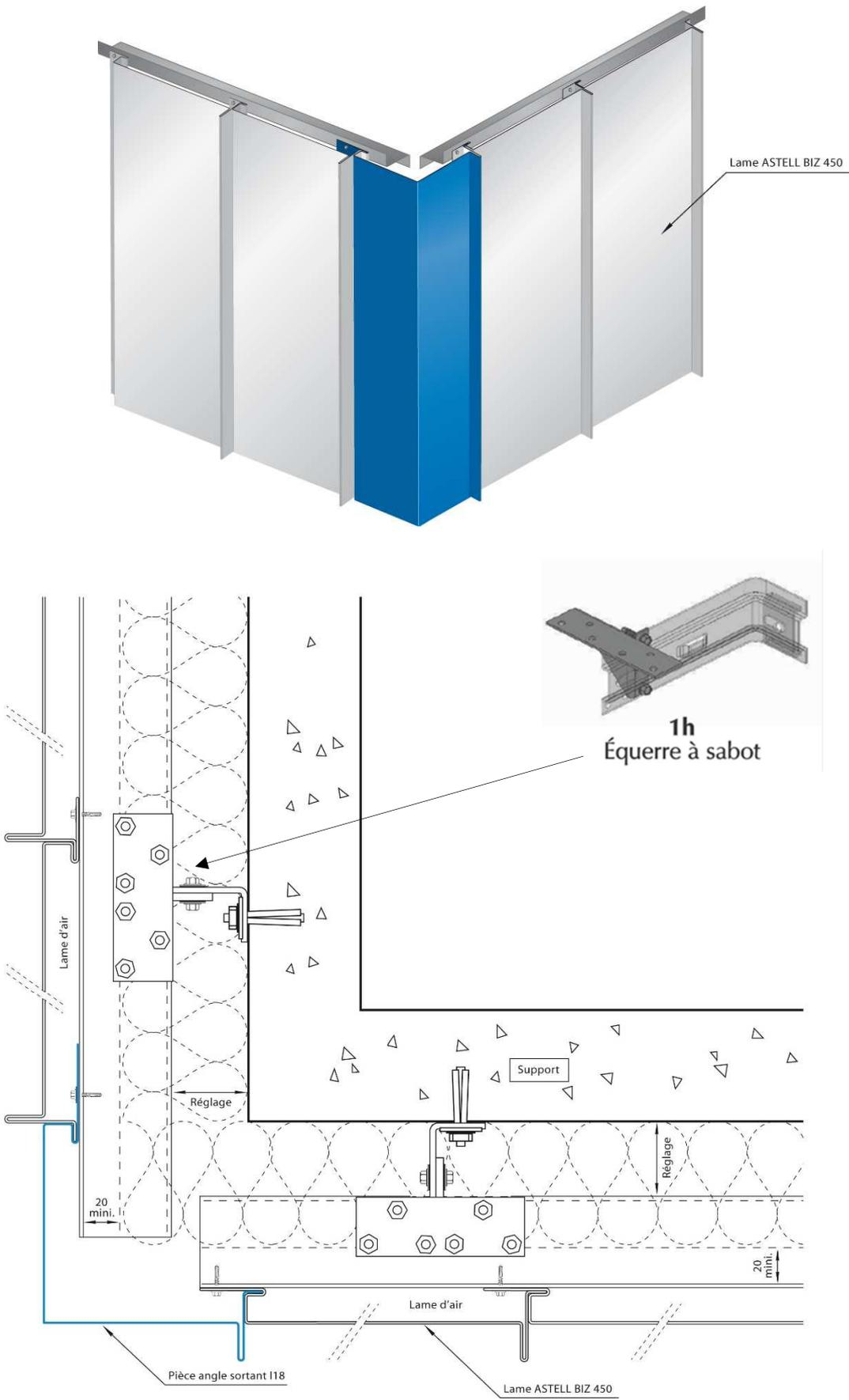
**Figure 23 – Détail angle sortant pose verticale**
