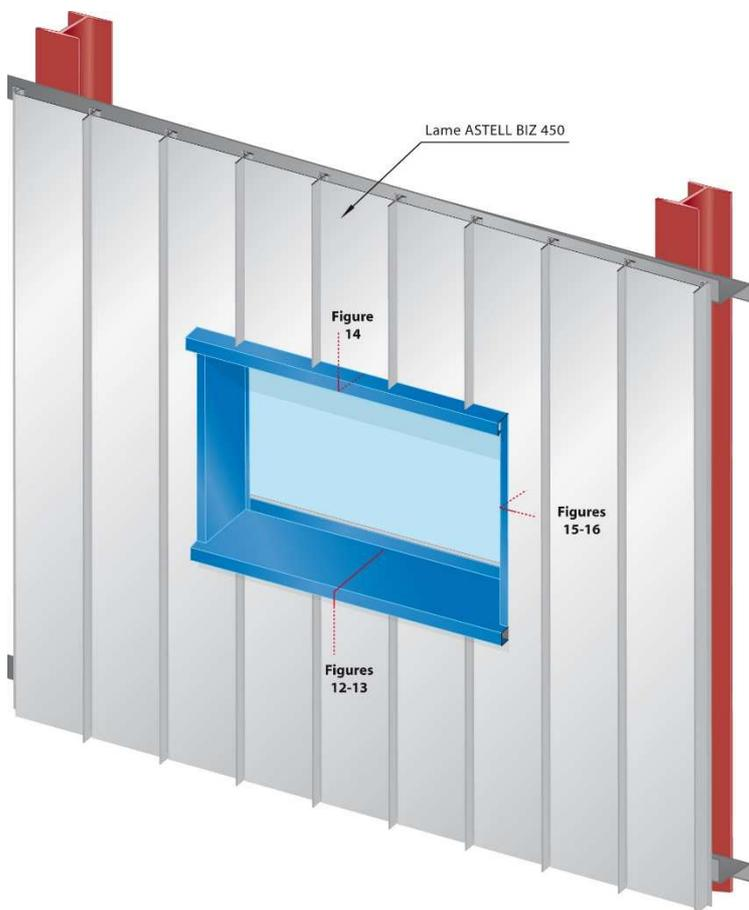
**Figure 11 – Encadrement ouvertures en pose horizontale et verticale**
