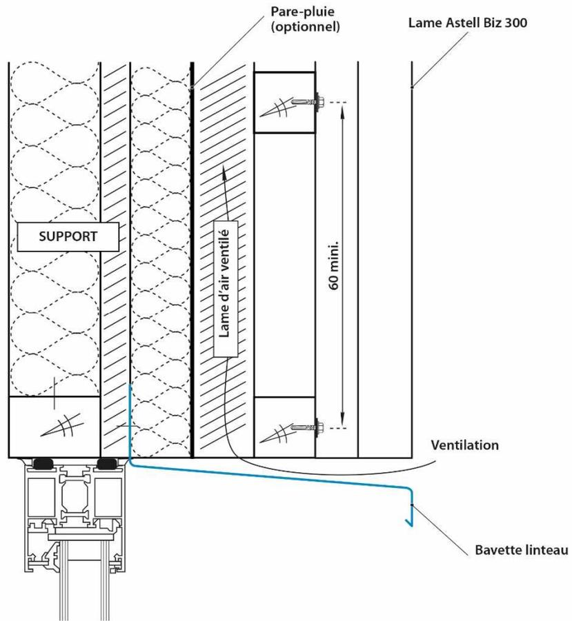
Figure 29 A-1 -Détails linteaux (pose COB et CLT)
