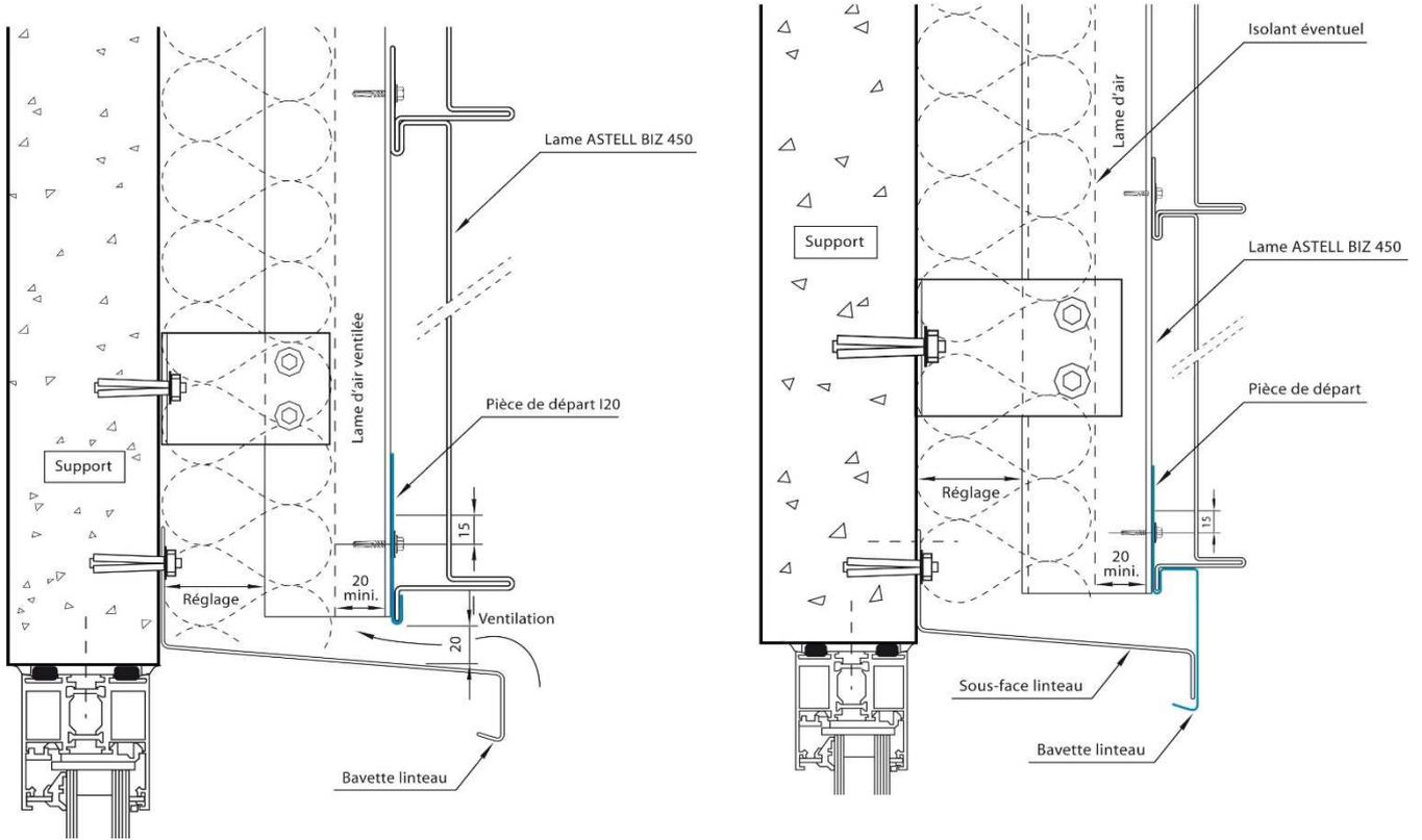
**Figure 14.1 et 14.2 – Détails linteaux I20 (pose rapportée)**
