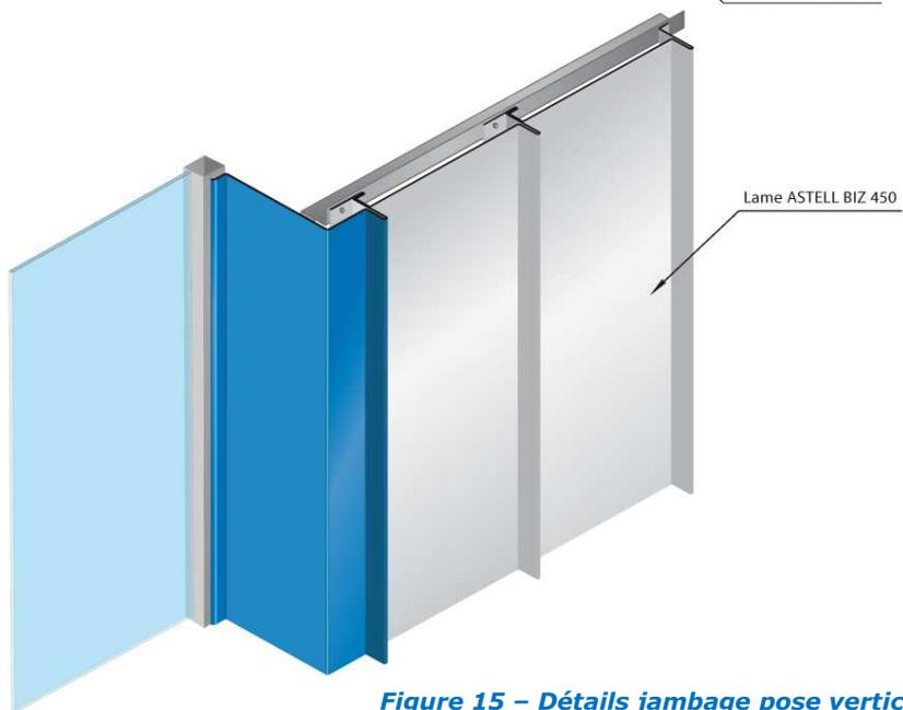
**Figure 15 – Détails jambage pose verticale**
