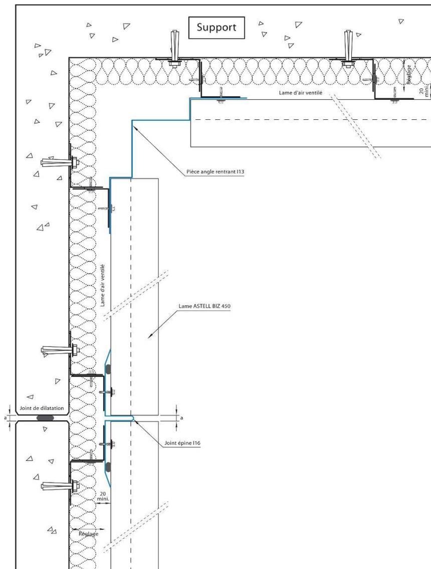
**Figure 21 – Détails angle rentrant 2 Pose horizontale**
