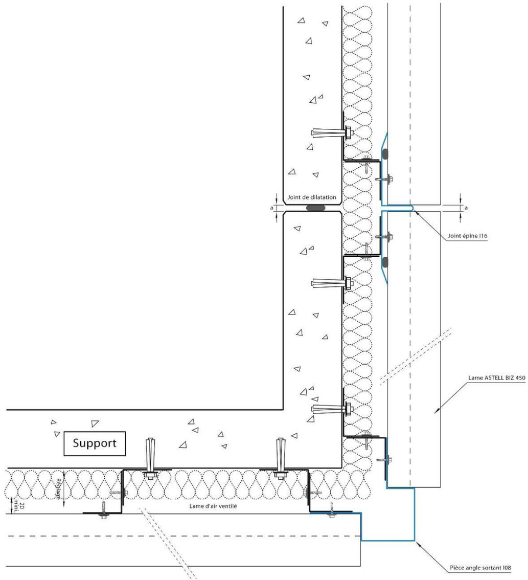
Figure 17 – Détails angle sortant
