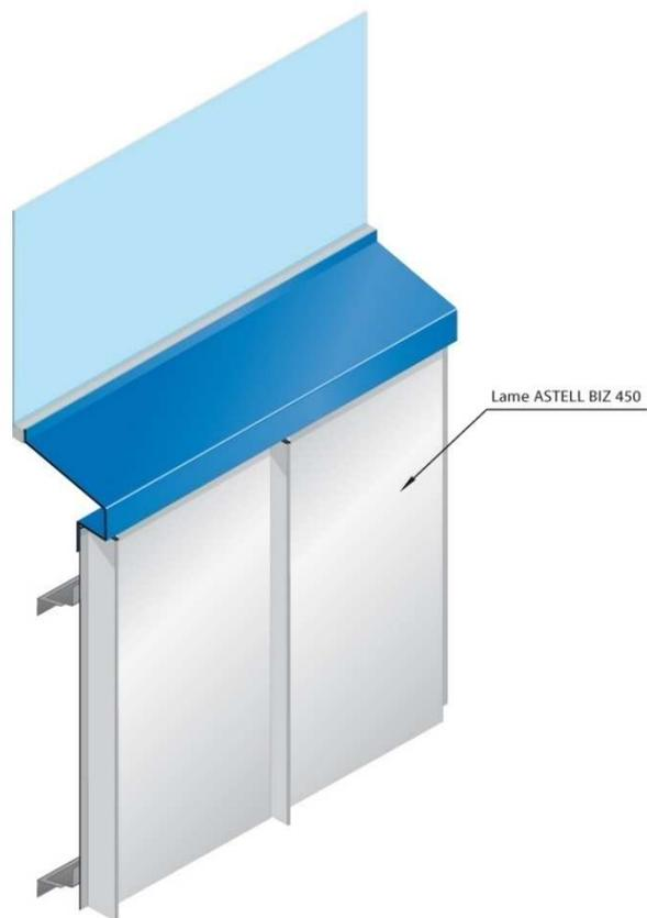
**Figure 12a et b – Détail appui 1 : pose rapportée (a) et pose en double peau (b) en pose verticale**
