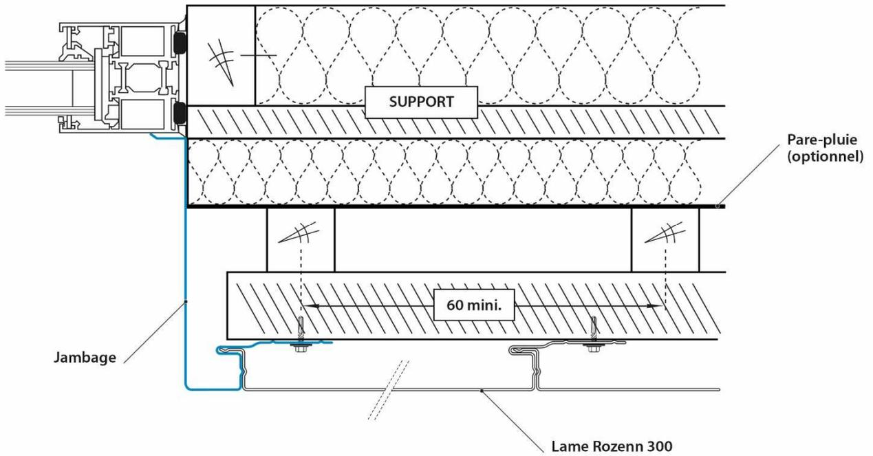
Figure 29 B-1 -Détails jambage (pose COB et CLT)
