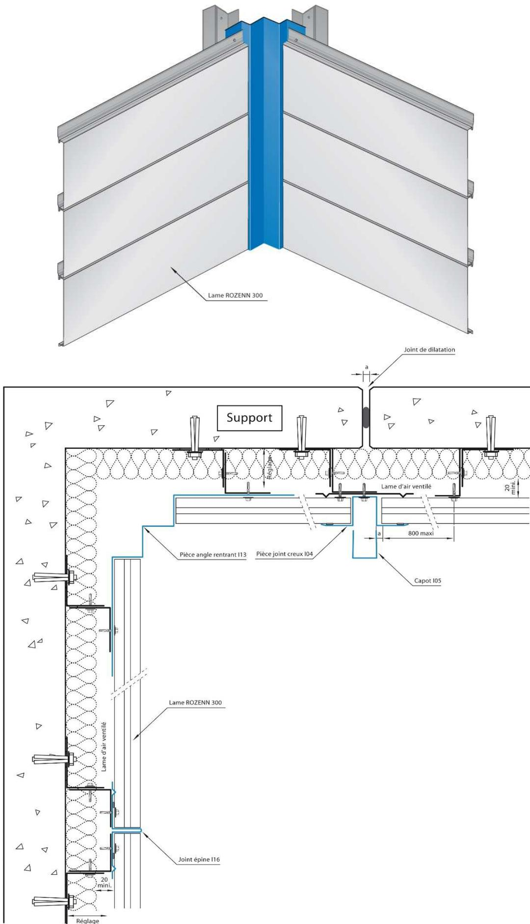
**Figure 21 – Détails angle rentrant 2 Pose horizontale**
