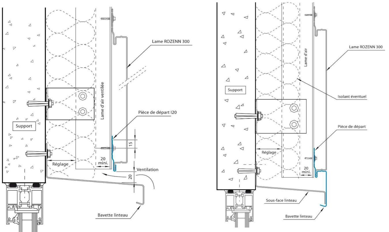
Figure 14.1 et 14.2 – Détails linteaux I20 (pose rapportée)
