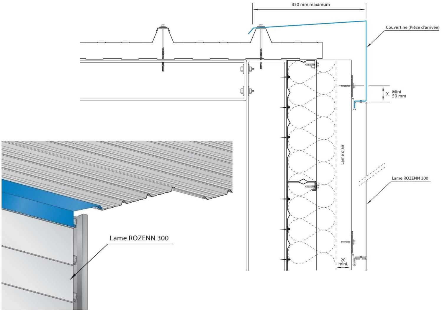
*Figure 10.3 – Détail acrotère 3 Coiffe avec panneaux sandwiches*
