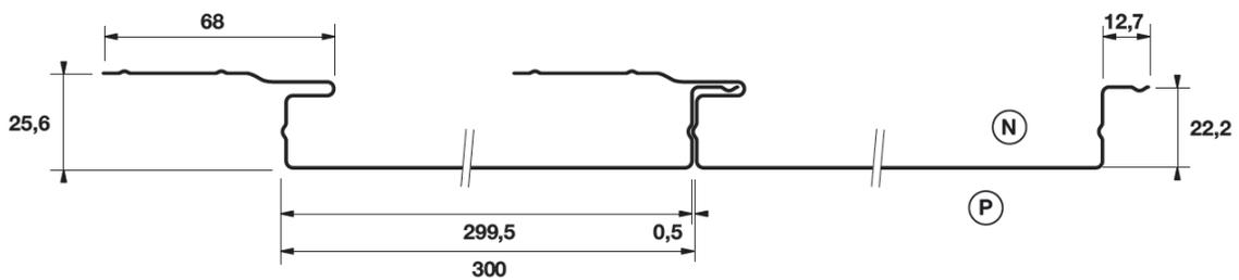
Figure 07.2 - Lame ROZENN 300 avec emboîtement joint serré - largeur utile 300
