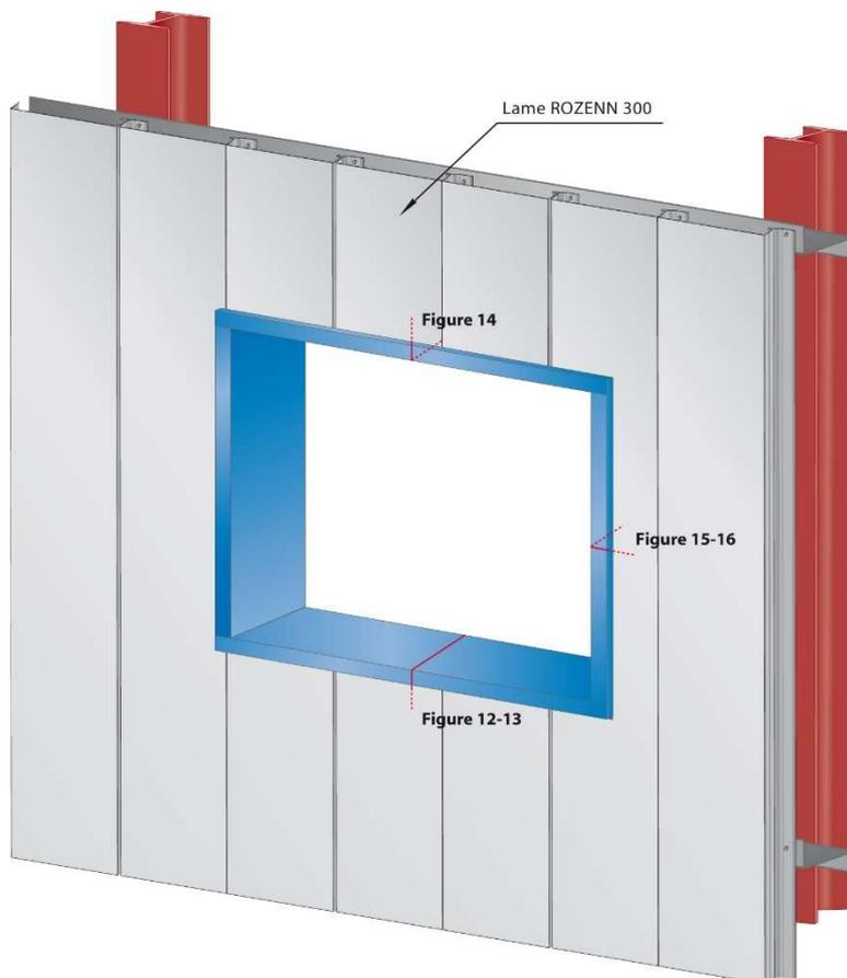
**Figure 11 – Encadrement ouvertures en pose horizontale et verticale**
