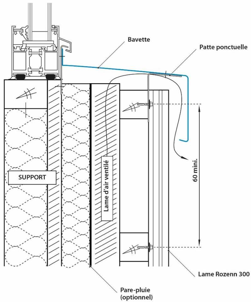
**Figure 29 C-1 -Détails appui (pose COB et CLT)**
