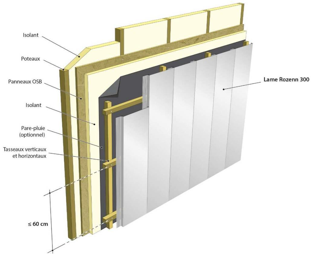
**Figure 27 – Principe de pose pour COB et CLT**
