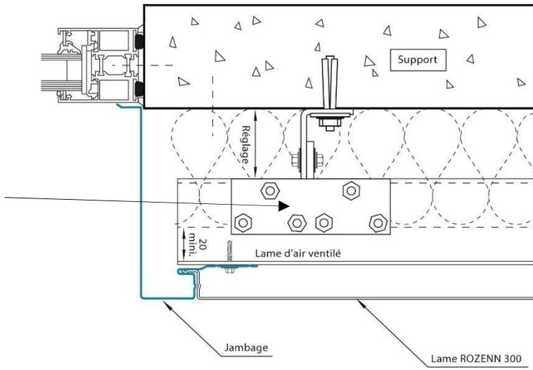
**Figure 15 – Détails jambage pose verticale**
