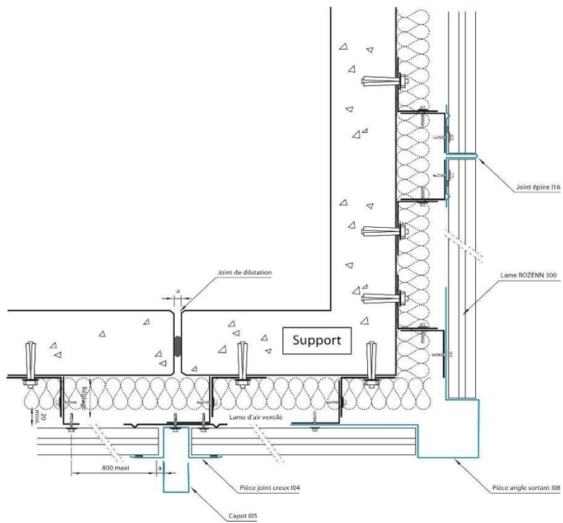
**Figure 17 – Détails angle sortant**
