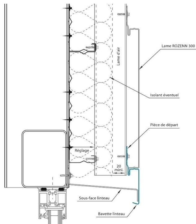
Figure 14.3 – Détails linteaux (pose en double peau)
