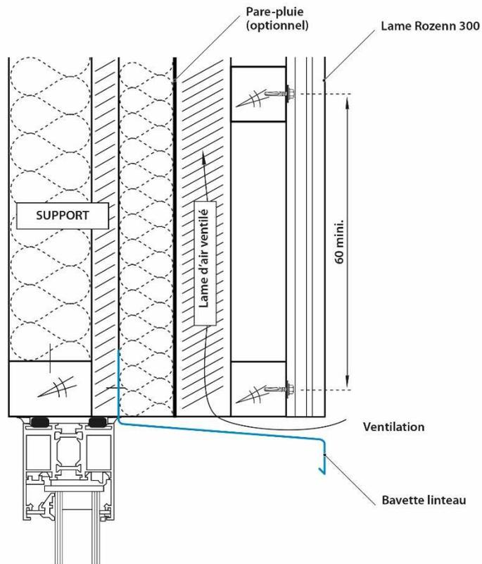
Figure 29 A-1 -Détails linteaux (pose COB et CLT)
