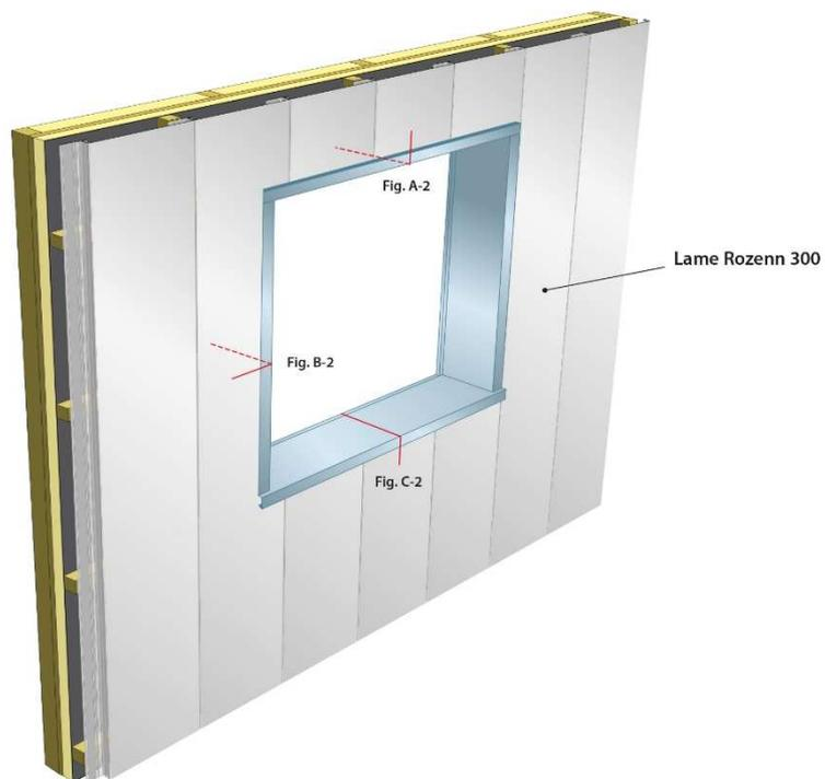
**Figure 28 – Encadrement ouvertures pour COB et CLT**
