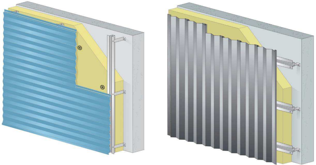
Principe de pose en bardage rapporté : bardage horizontal à gauche et bardage vertical à droite
