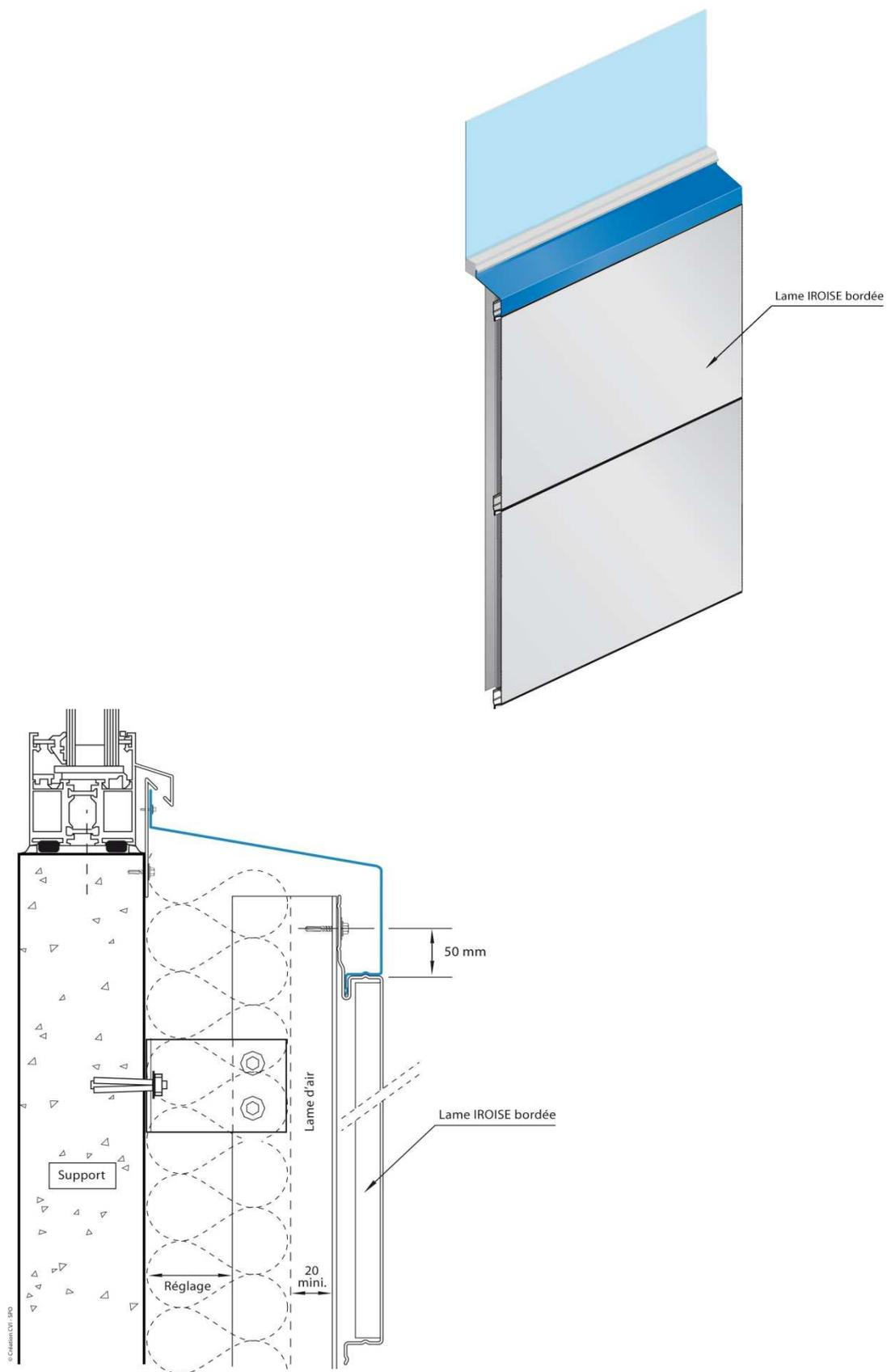
**Figure 13 – Détail appui 2 en pose horizontale**
