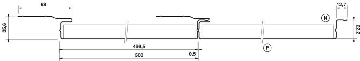
*Figure 08.2 - Lame IROISE 500 bordée avec emboîtement joint serré - largeur utile 500*
