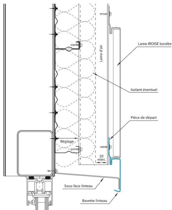
Figure 14.3 – Détails linteaux (pose en double peau)
