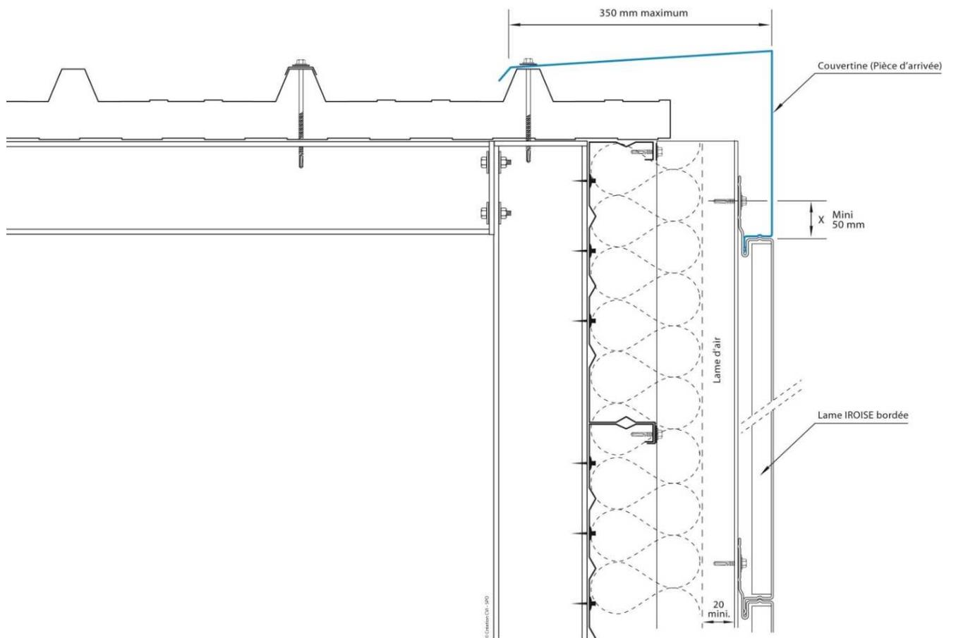
**Figure 10.3 – Détail acrotère 3 Coiffe avec panneaux sandwiches**
