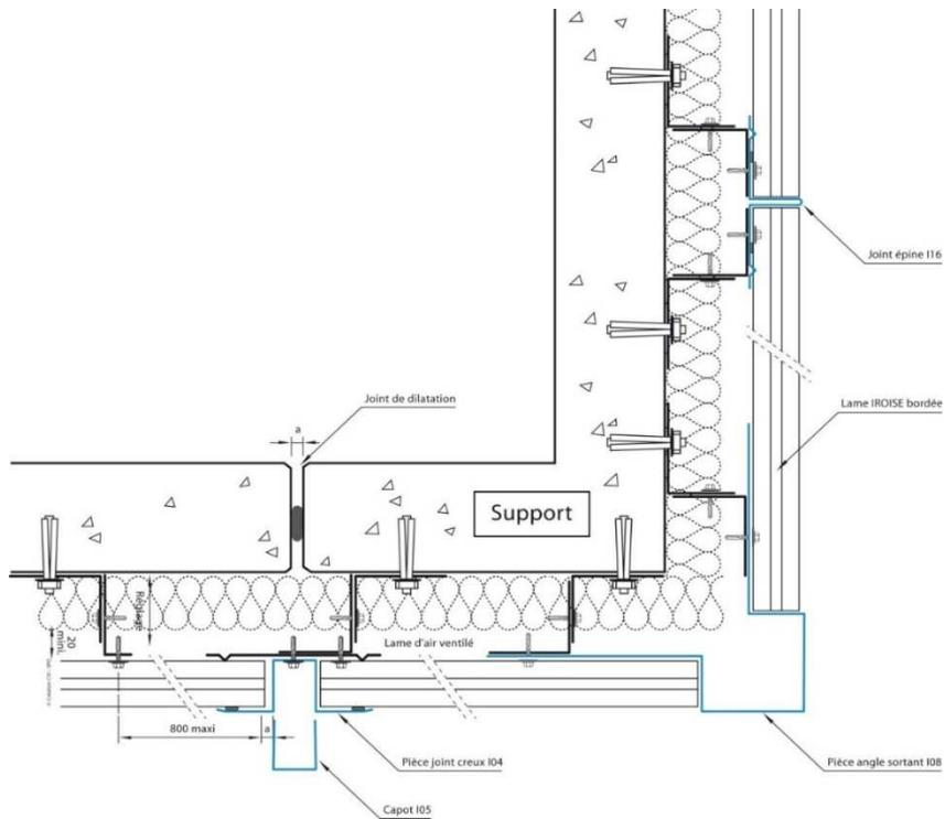
**Figure 17 – Détails angle sortant**
