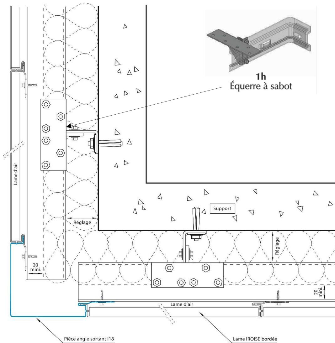
**Figure 23 – Détail angle sortant pose verticale**
