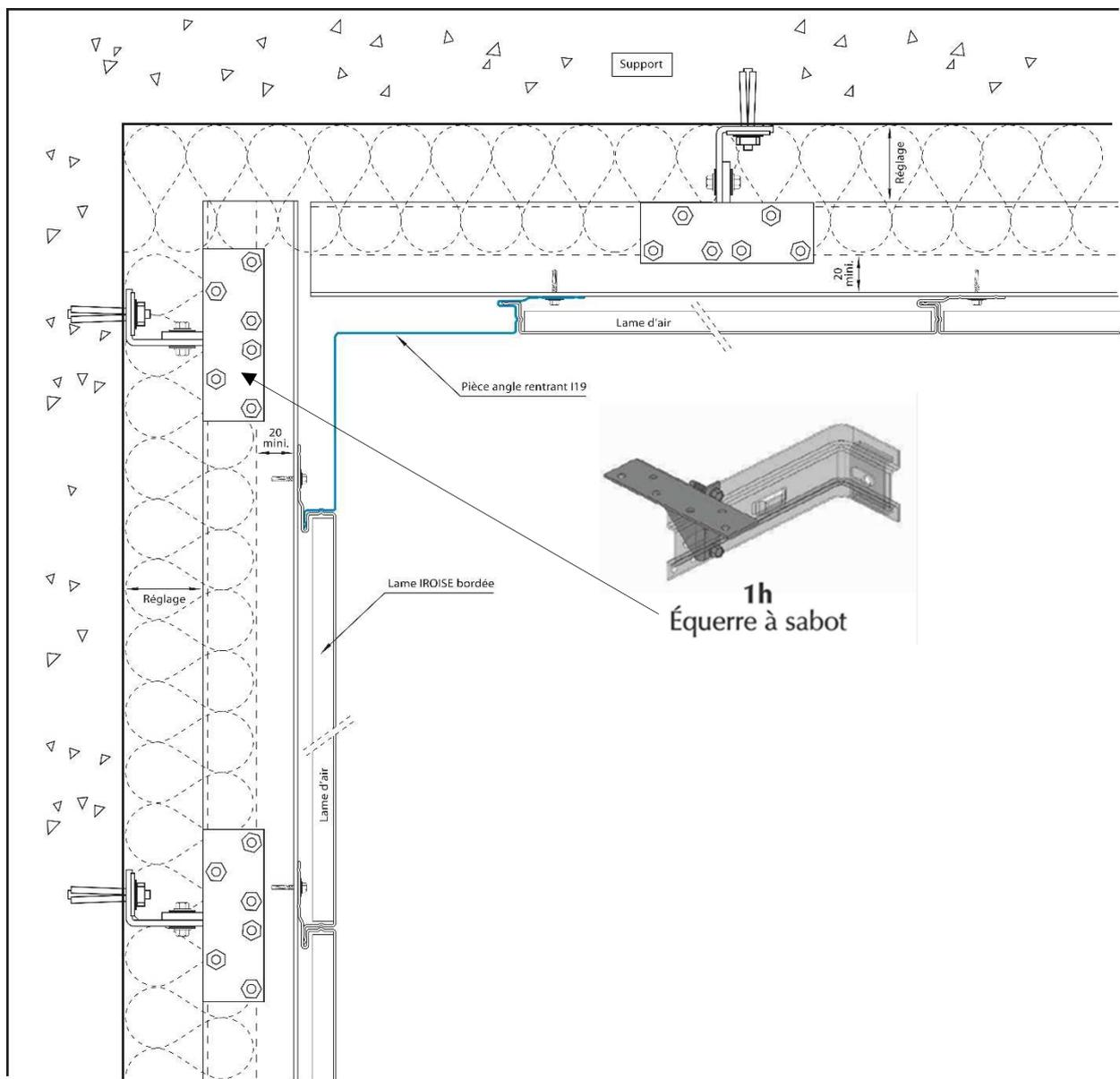
Figure 24 – Détail angle rentrant pose verticale
