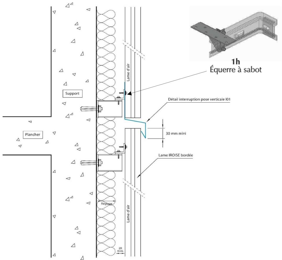
**Figure 25 – Détail fractionnement pose verticale**
