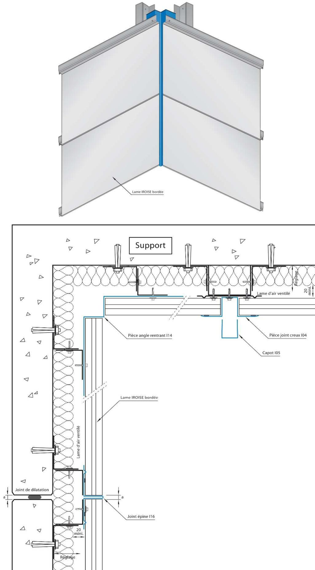
**Figure 20 – Détails angle rentrant 1 Pose horizontale**
