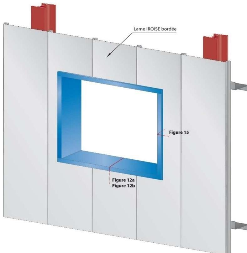
**Figure 11 – Encadrement ouvertures (pose horizontale et verticale)**
