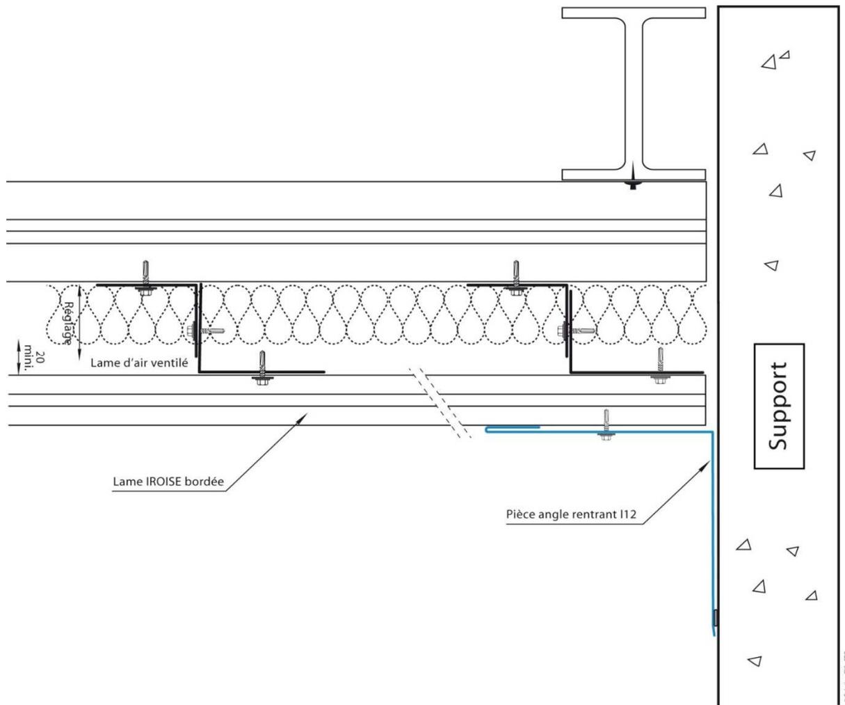
**Figure 22 – Détails angle rentrant simple**
