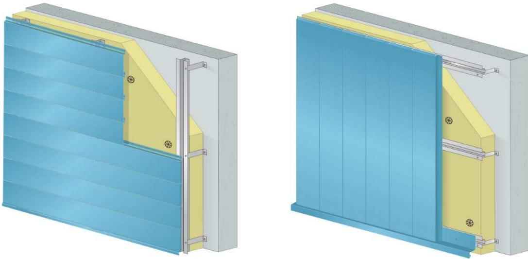
*Figure 08.1c et d – Types de pose des lames ASTELL 200*
