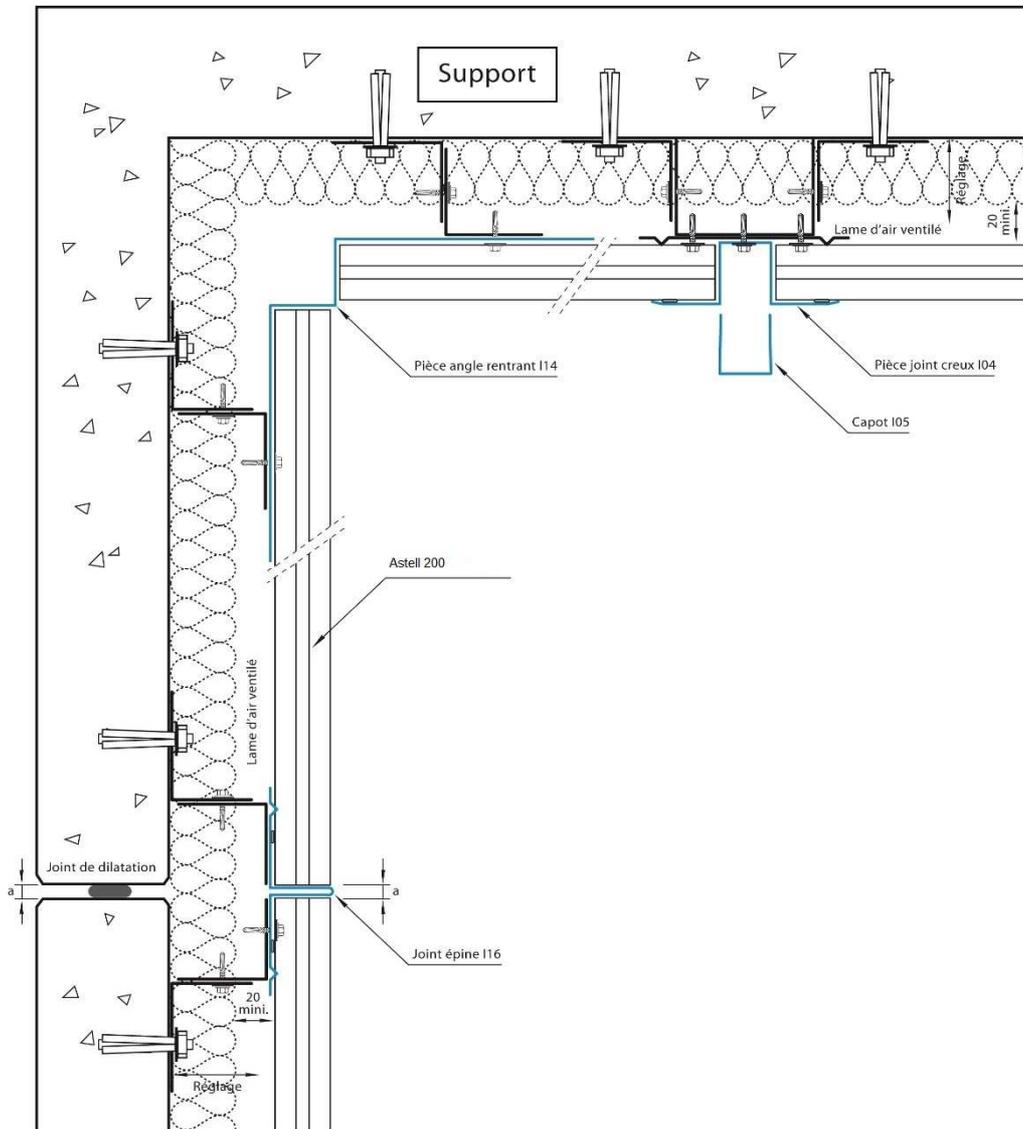
Figure 20 – Détails angle rentrant 1 Pose horizontale
