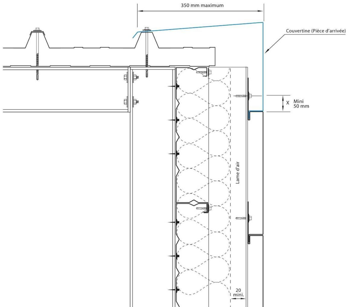
**Figure 10.3 – Détail acrotère 3 Coiffe avec panneaux sandwiches**
