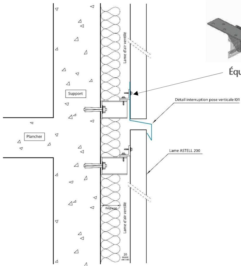
**Figure 25 – Détail fractionnement pose verticale**
