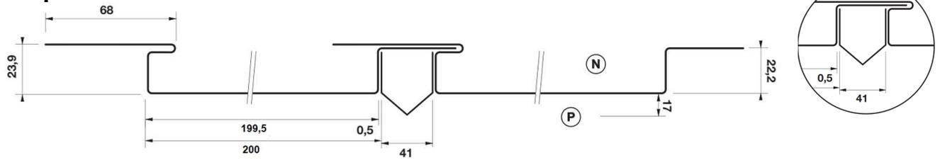
Figure 07.1 - Lame ASTELL 200 avec emboîtement joint creux – largeur utile 241
