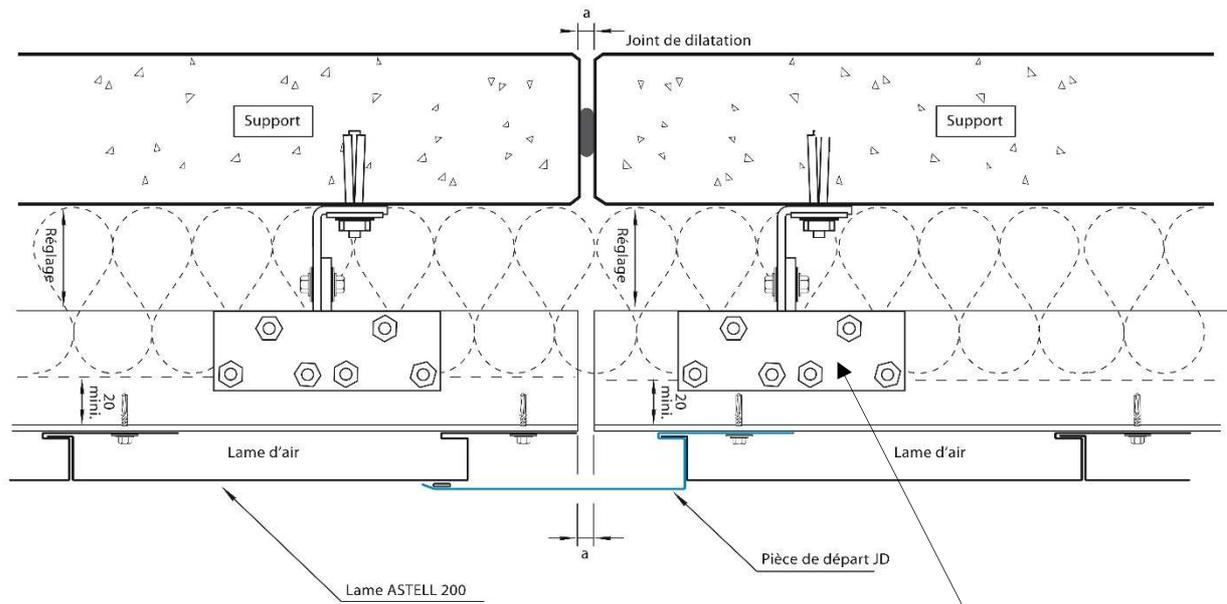
**Figure 26 – Détail joint de dilatation pose verticale**
