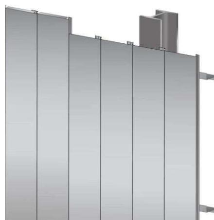
*Principe de pose en simple peau : bardage horizontal à gauche et bardage vertical à droite*
