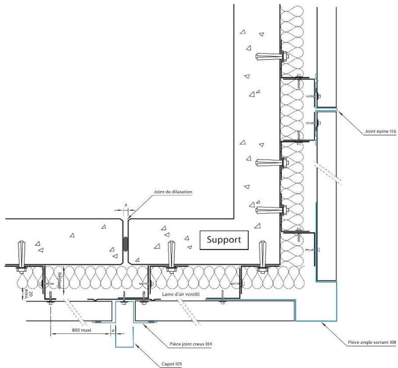
**Figure 17 – Détails angle sortant**
