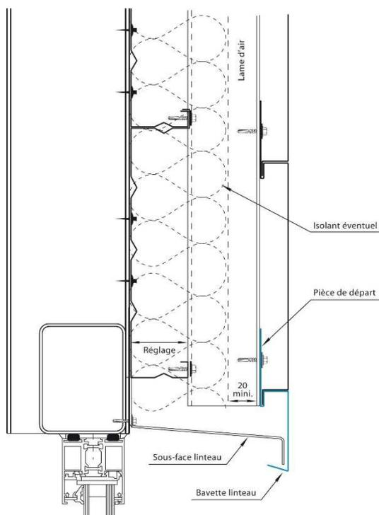
**Figure 14.3 – Détails linteaux (pose en double peau)**
