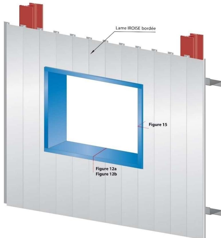
**Figure 11 – Encadrement ouvertures en pose horizontale et verticale**
