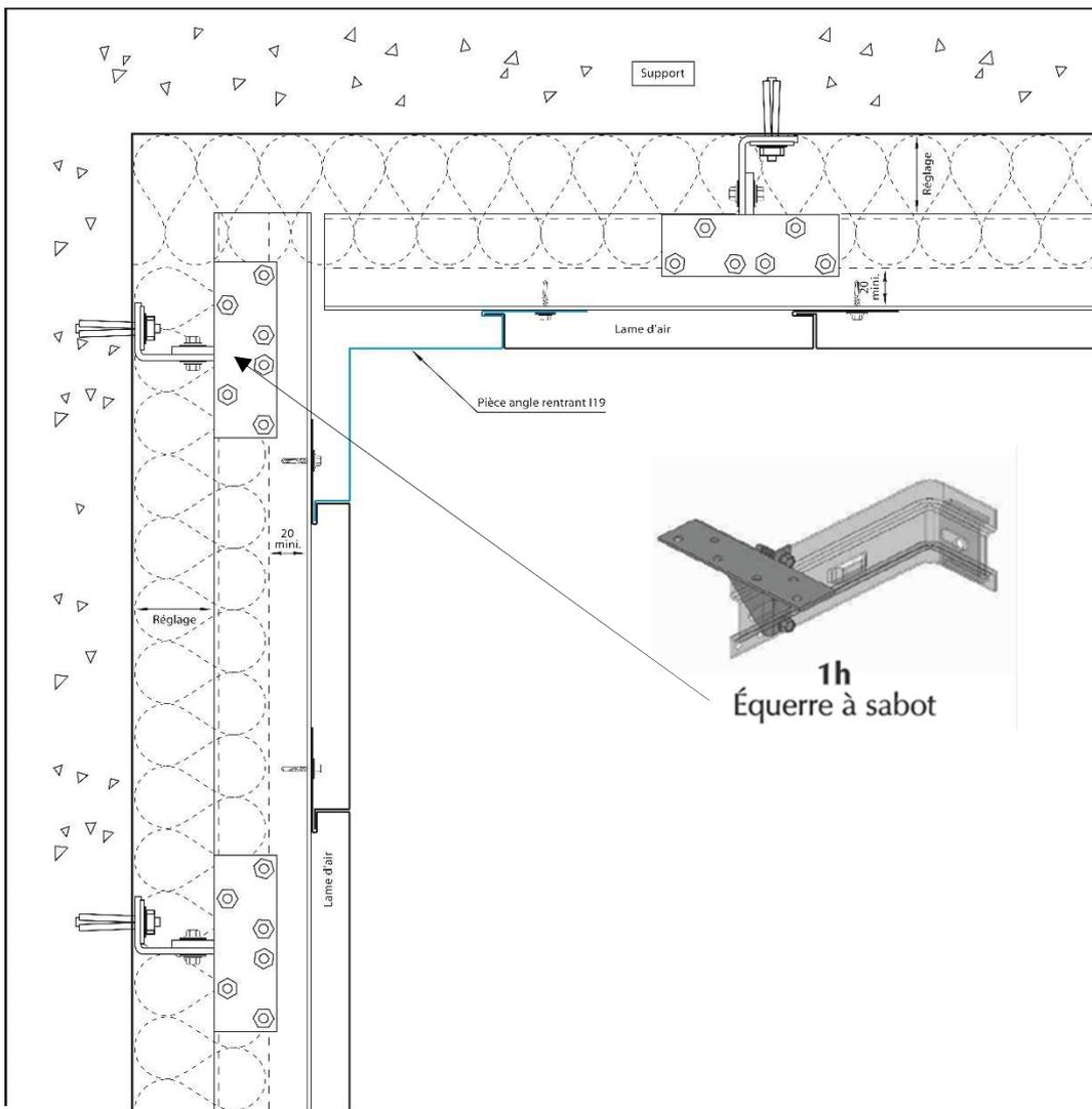
Figure 24 – Détail angle rentrant pose verticale
