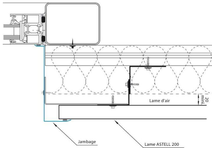
**Figure 16 – Détails jambage pose horizontale**
