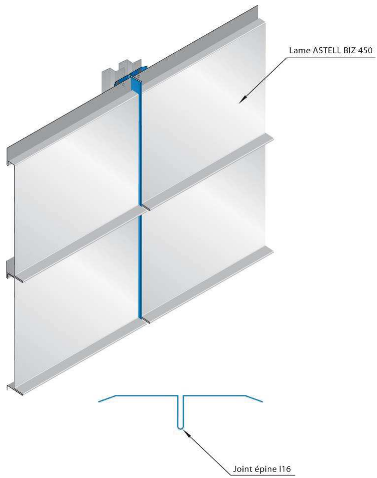
Figure 17.1 Détail joint épine, pose horizontale
