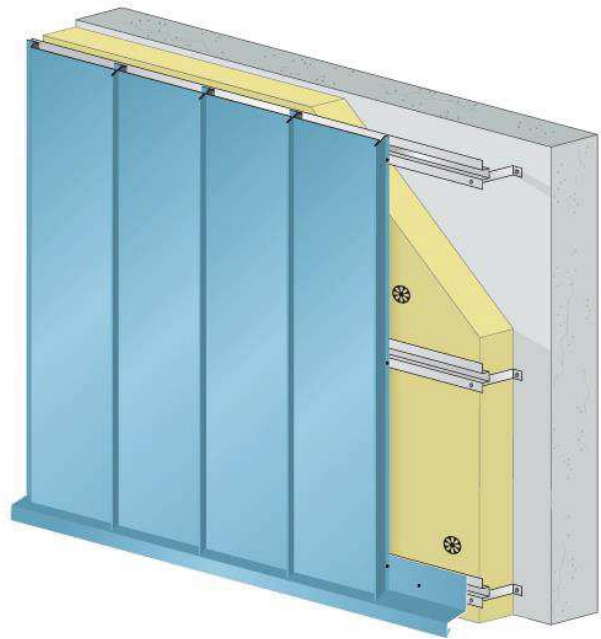
Figure 08.1c et d – Types de pose des lames ASTELL BIZ 450
