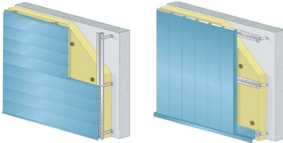
Principe de pose en bardage rapporté : bardage horizontal à gauche et bardage vertical à droite
