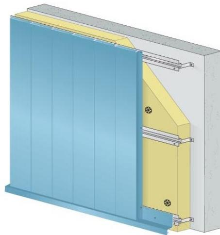
Figure 08.1c et d – Types de poses des lames IROISE 300 bordées
