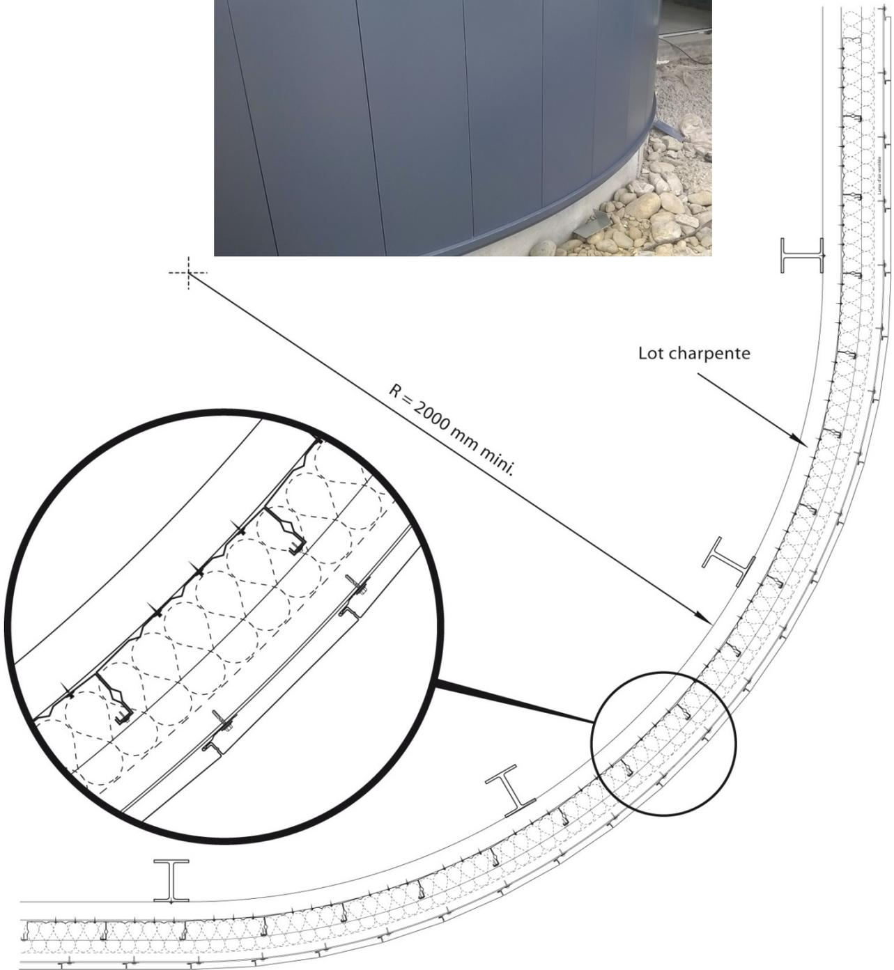
Figure 27 - Détail pose verticale cintrée
