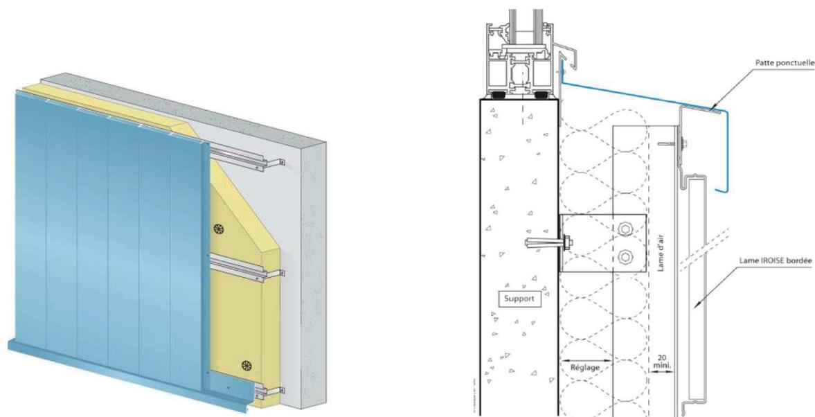
*Principe de pose en bardage rapporté : bardage vertical à gauche et bardage horizontal à droite*
