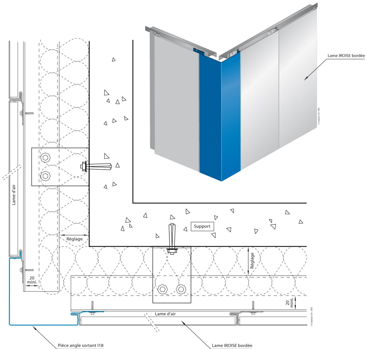
**Figure 23 – Détail angle sortant pose verticale**
