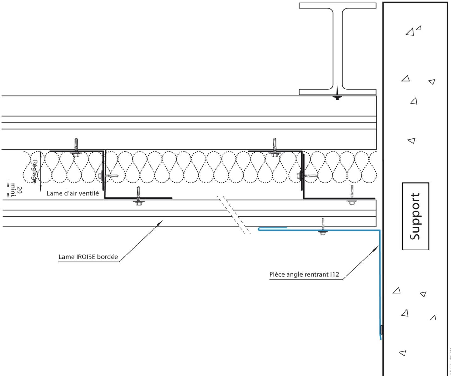
Figure 22 – Détails angle rentrant simple
