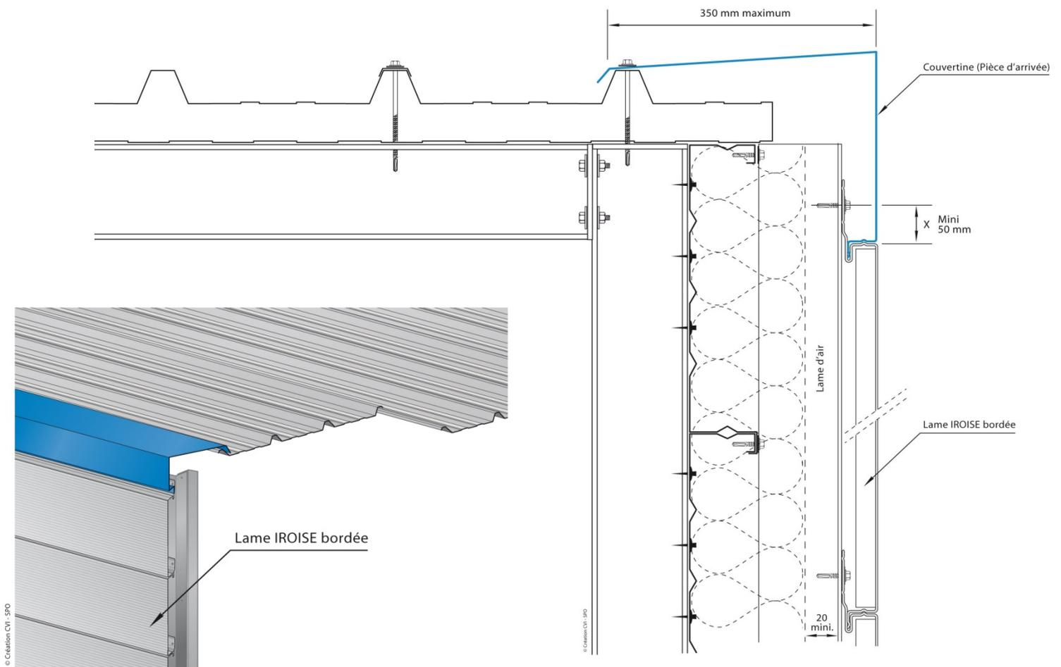
**Figure 10.3 – Détail acrotère 3 Coiffe avec panneaux sandwichs**
