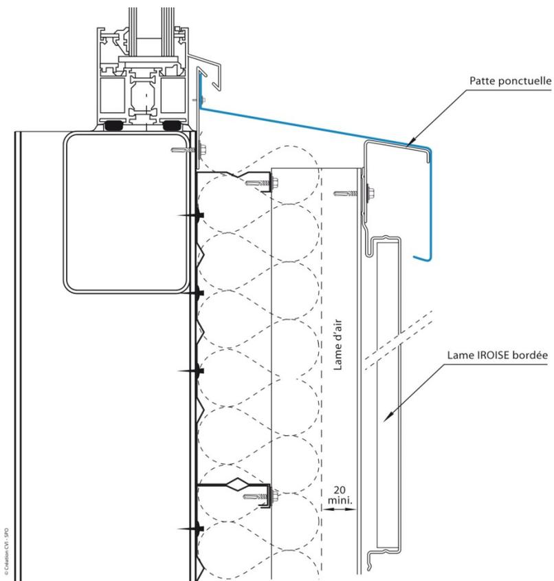
Figure 12.2 – Détail appui 1 (pose en double peau)
