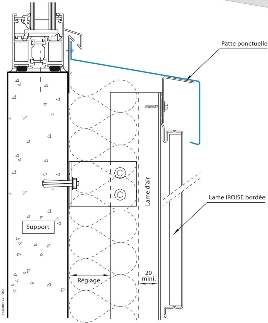
**Figure 12.1 - Détail appui 1 (pose rapportée)**
