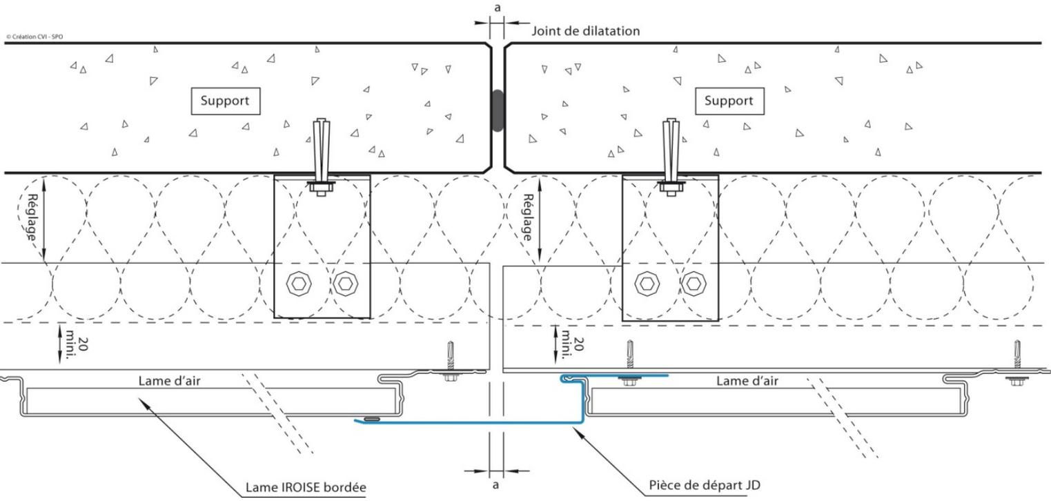
**Figure 26 – Détail joint de dilatation pose verticale**
