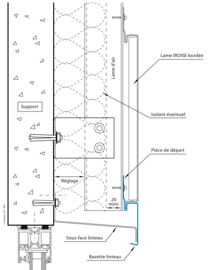
Figure 14.1 et 14.2 – Détails linteaux (pose rapportée)
