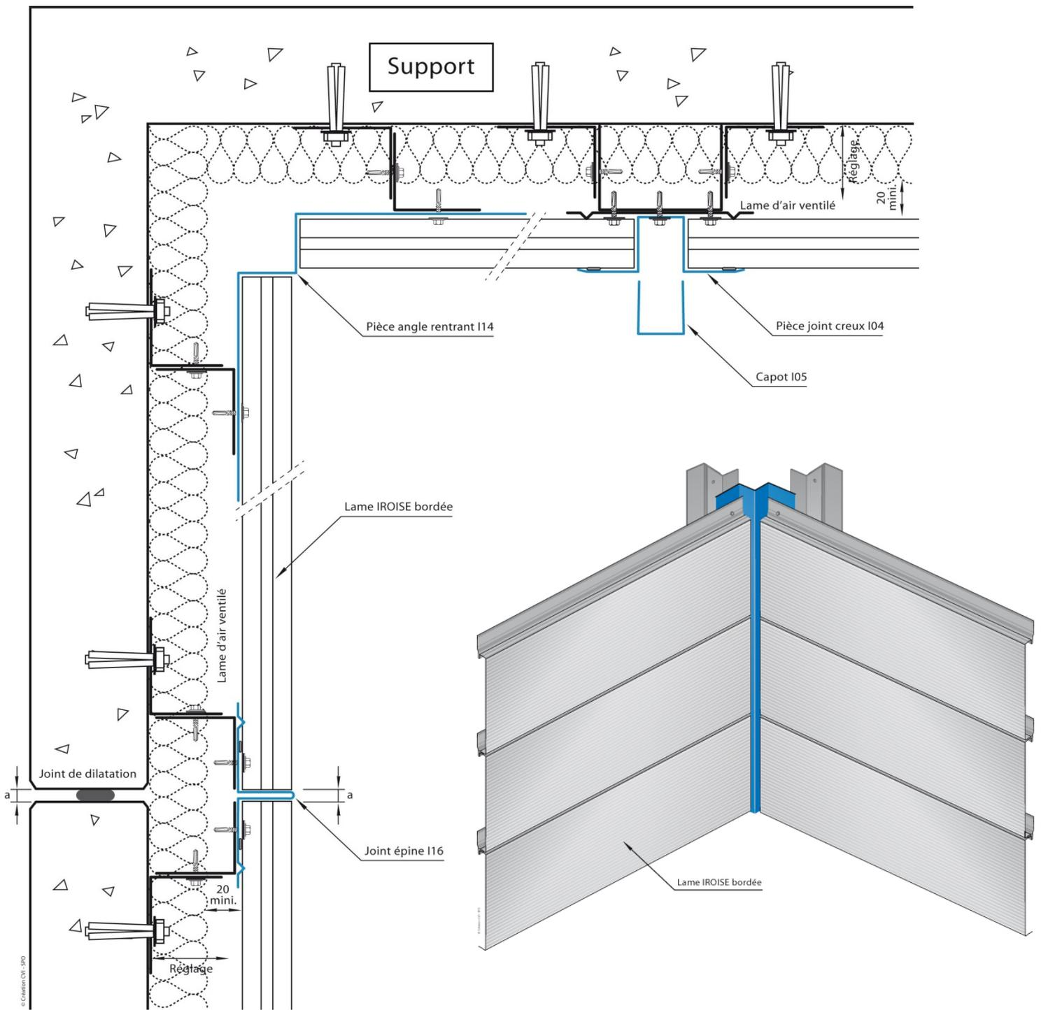
Figure 20 - Détails angle rentrant 1
