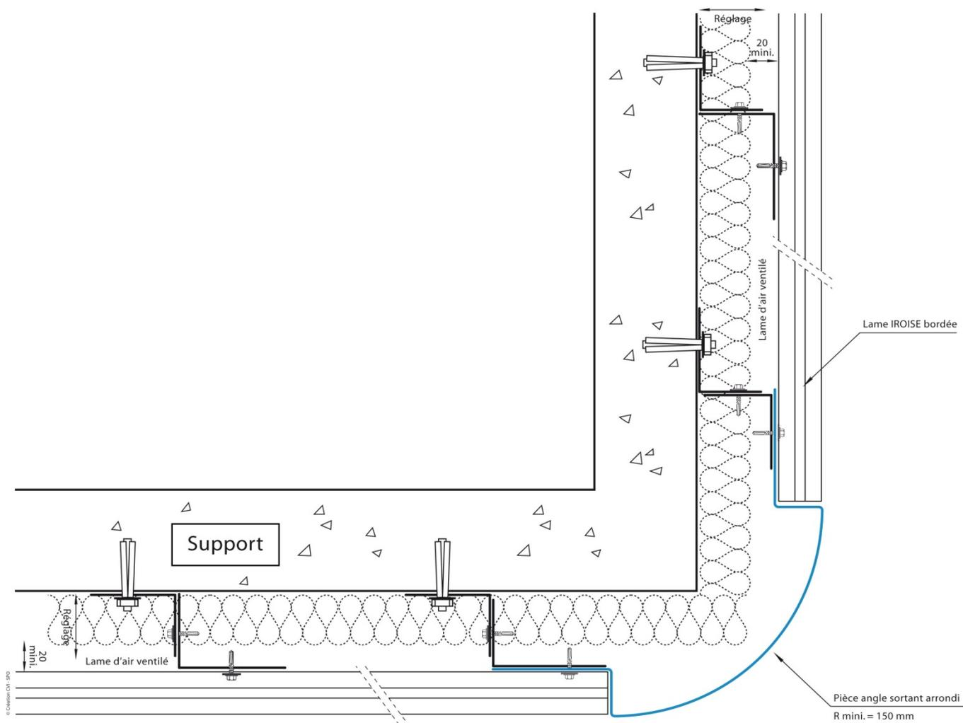
Figure 18 - Détails angle sortant arrondi
