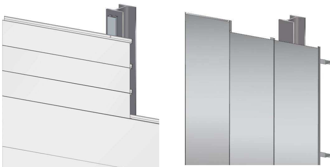
Principe de pose en simple peau : bardage horizontal à gauche et bardage vertical à droite
