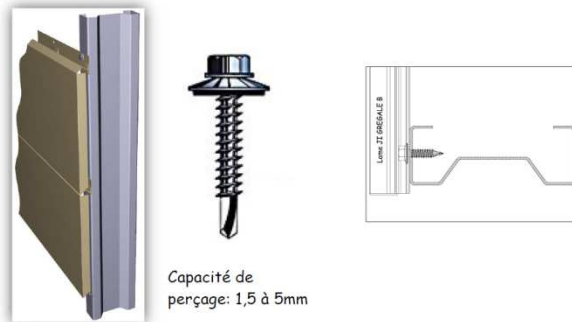
Figure 13 - Vis TETINOX P1 et P5, TH P5 et INOX P3 pour fixation dans support métallique de 1,5 mm d'épaisseur.
