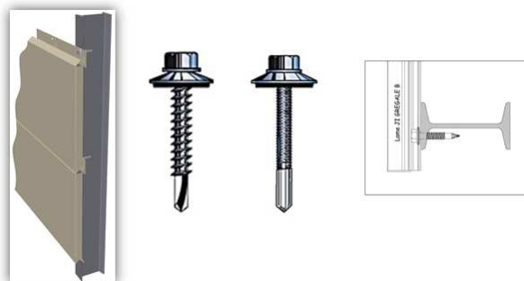
Figure 15 - Vis TETALU P13 et INOX P13 autoperceuse 5,5 x L pour fixation dans semelle de profilé métallique laminé à chaud d'épaisseur supérieure à 5 mm
