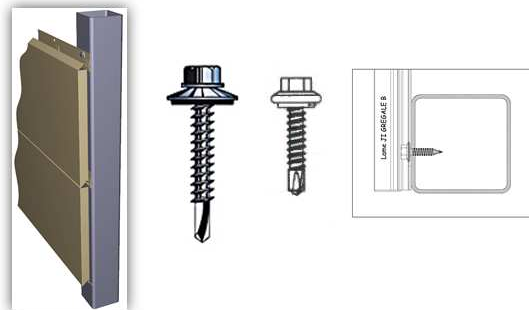
Figure 14 - Vis TETINOX P5 6,3 x L ; TH P5 5,5 x L et INOX P5 5,5 x L pour fixation dans support métallique d'épaisseur minimum 2 mm et jusqu'à 5 mm inclus
