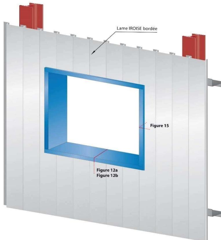
**Figure 11 – Encadrement ouvertures en pose horizontale et verticale**
