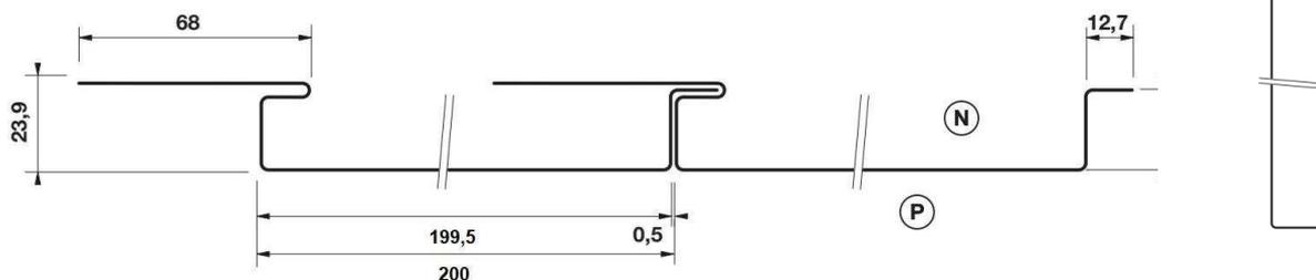
Figure 07.2 - Lame ASTELL 200 avec emboîtement joint serré - largeur utile 200
