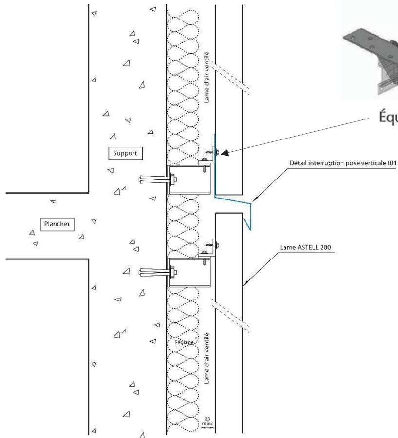
**Figure 25 – Détail fractionnement pose verticale**
