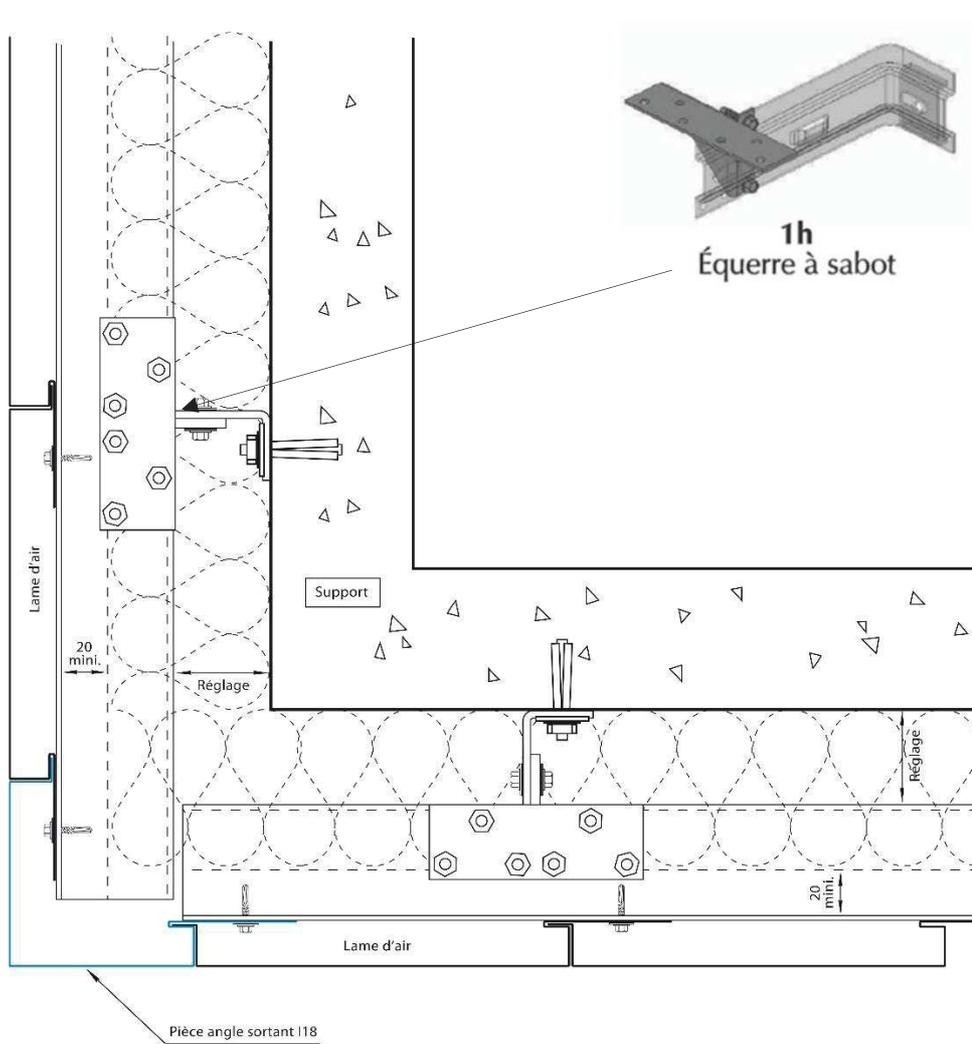
**Figure 23 – Détail angle sortant pose verticale**
