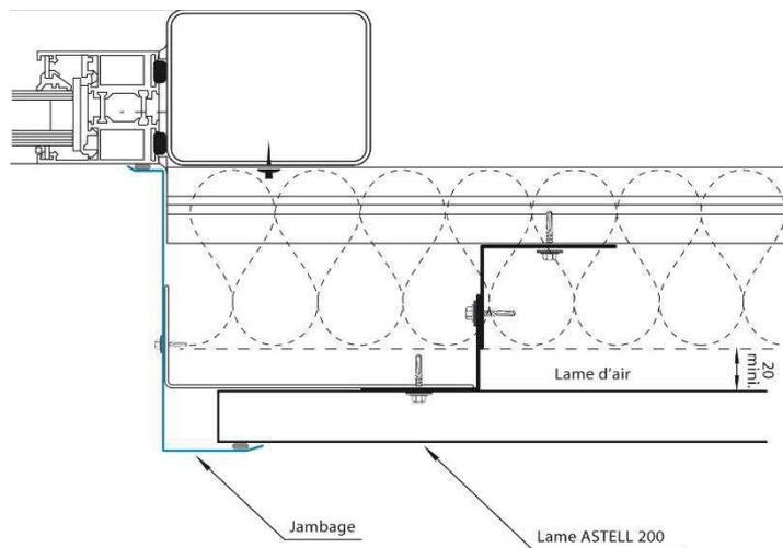
**Figure 16 – Détails jambage pose horizontale**
