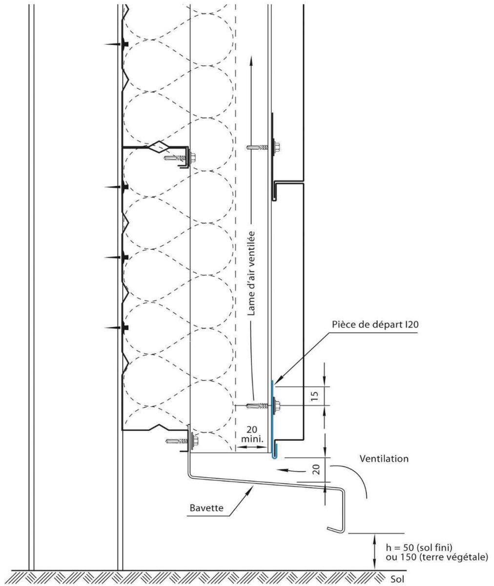
**Figure 09.2 – Pièce de départ 1 - I20 (pose en double peau)**
