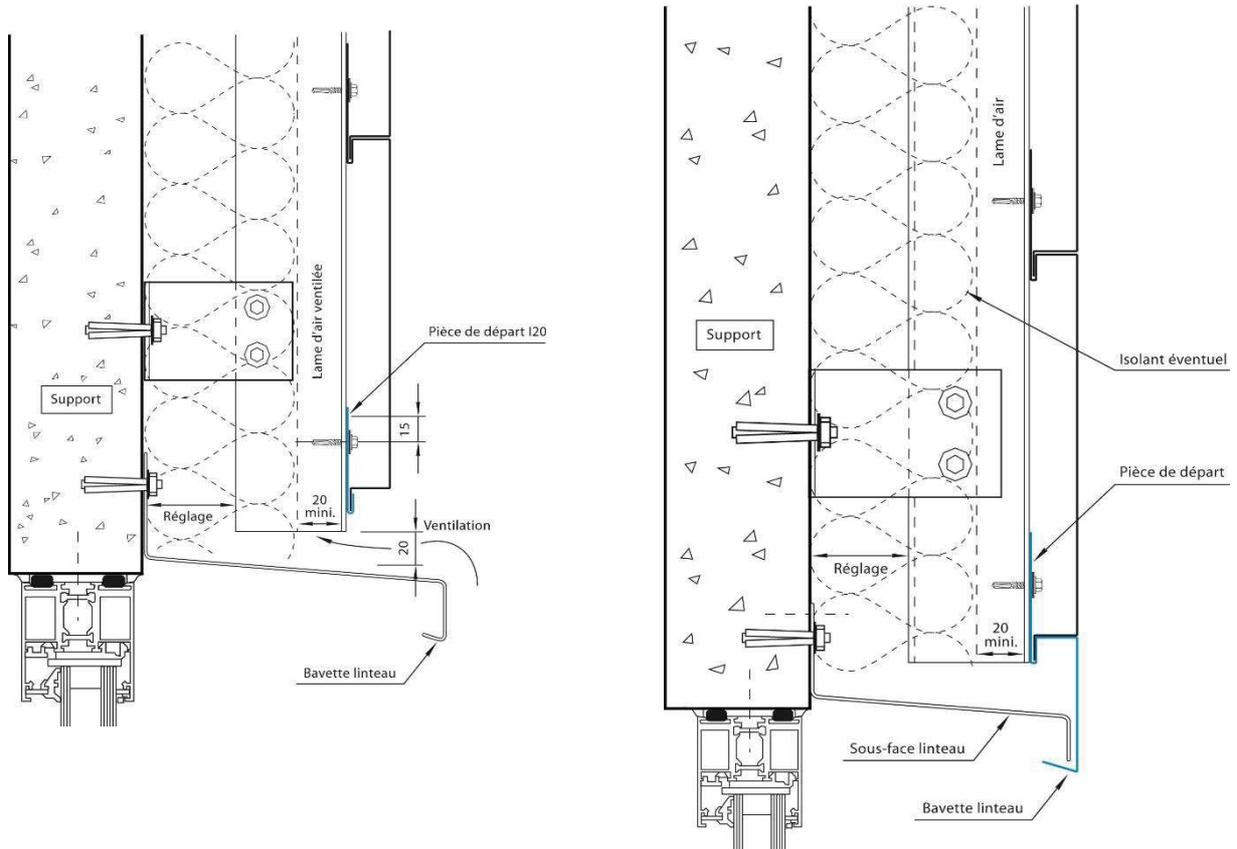
**Figure 14.1 et 14.2 – Détails linteaux I20 (pose rapportée)**
