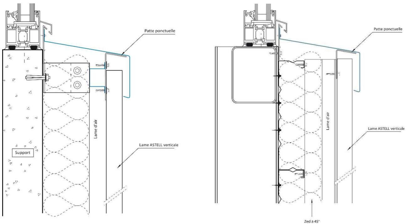
**Figure 12a et b – Détail appui 1 : pose rapportée (a) et pose en double peau (b) en pose verticale**
