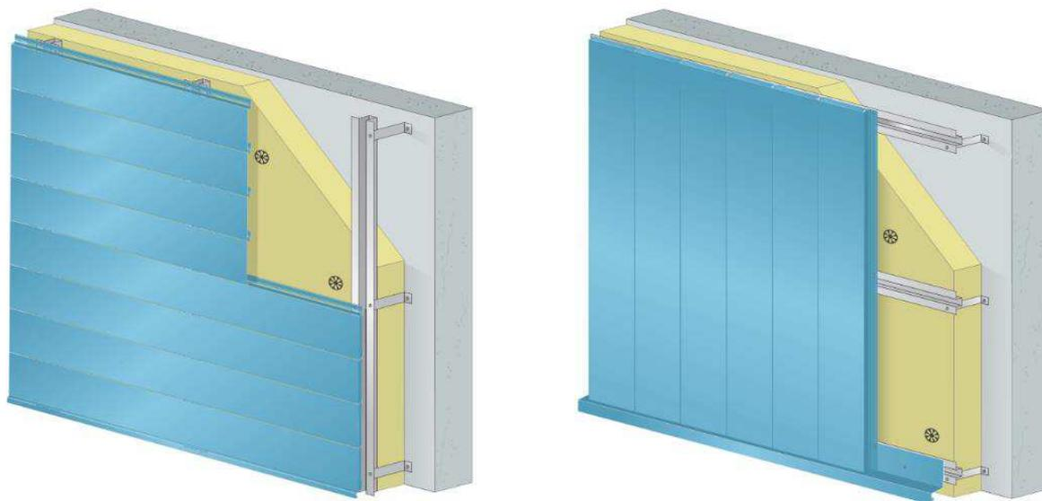
*Principe de pose en bardage rapporté : bardage horizontal à gauche et bardage vertical à droite*
