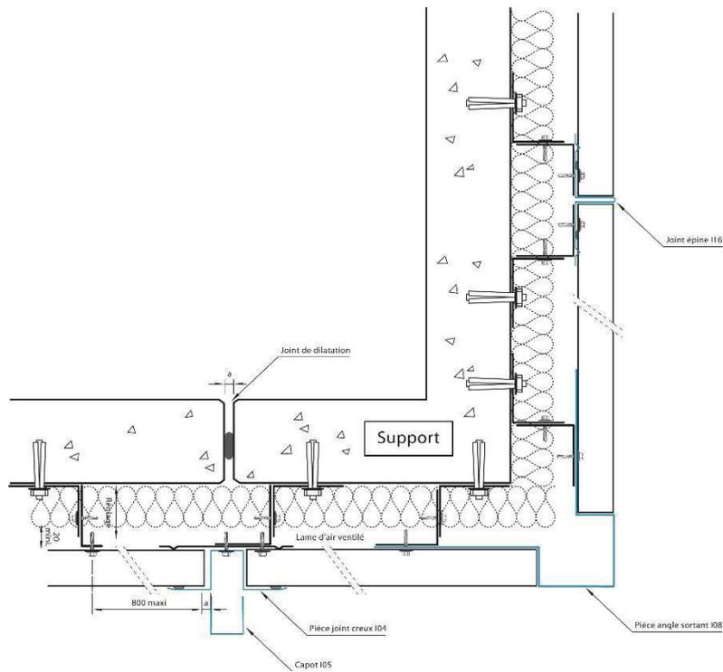
**Figure 17 – Détails angle sortant**
