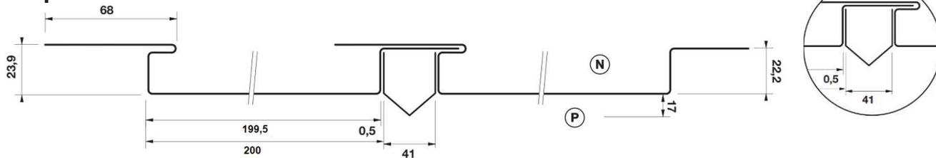
Figure 07.1 - Lame ASTELL 200 avec emboîtement joint creux – largeur utile 241
