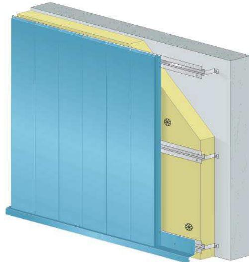
*Figure 08.1c et d – Types de pose des lames ASTELL 200*
