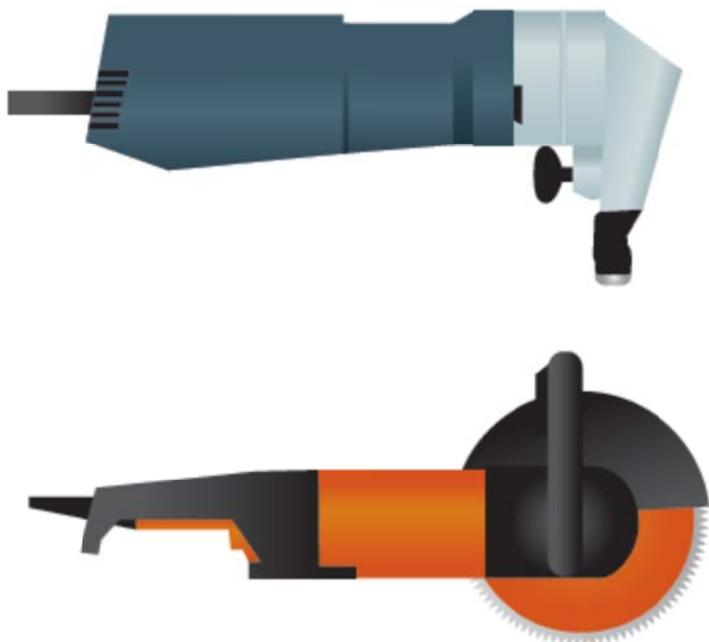
La découpe des profils s'effectue soit à la grignoteuse soit à la disqueuse. Dans le cas de profils prélaqués, l'utilisation de la disqueuse est déconseillée.
