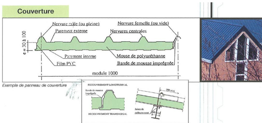
L'épaisseur de l'isolant est fonction de l'usage industriel ou agroalimentaire des panneaux sandwich.
