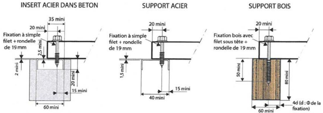
▲ Figure 8a : Appuis d'extrémités de panneaux sandwich
