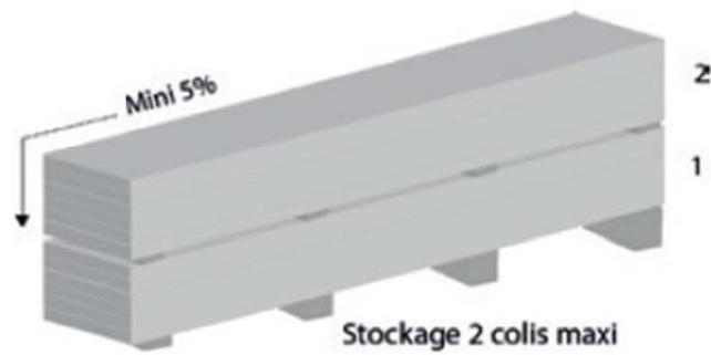
▲ Figure 14 : Stockage des panneaux sur chantier
