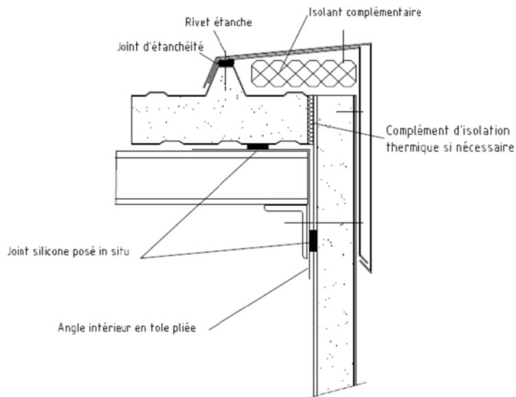
**Détail 19 : Ouvertures - Panneau à fixation cachée en pose verticale**
