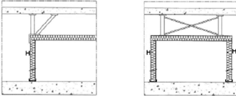
Figure 2 - exemple de triangulation du support de plafond
